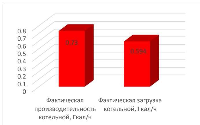
Рис. 49 Сравнение фактических показателей потребления и мощностей котельной №12 по ул. Лесная.
